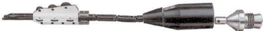
Nož sa točućima sa dodatkom glave za proširivanje i uvlačenje u kanal
